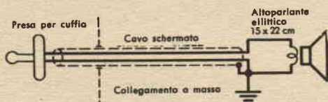
Fig. 3 - Adottando un altoparlante esterno, lo si deve collegare al ricevitore mediante un filo schermato. Usando il ricevitore portatile fuori dell'automobile, si rimetterà in funzione l'altoparlante ad esso incorporato.
